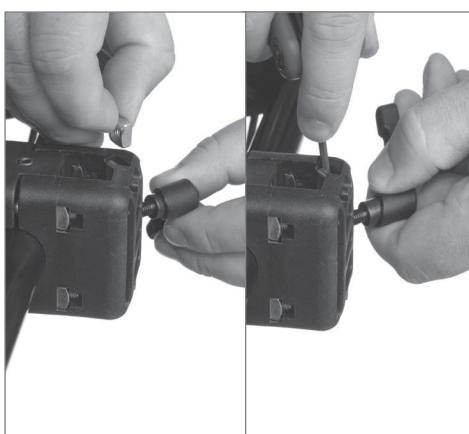
Za namještanje dubine, podložak za potkoljenicu se uklanja s nosača pomoći vlastog ključa između podloška i nosača. Namjestite željni položaj i ponovno ga pričvrstite.
