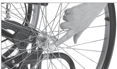
**i** Za provjeru je li glavni kotač pravilno pričvršćen na glavčinu, otpustite prst s centralnog gumba i povucite glavni kotač.
