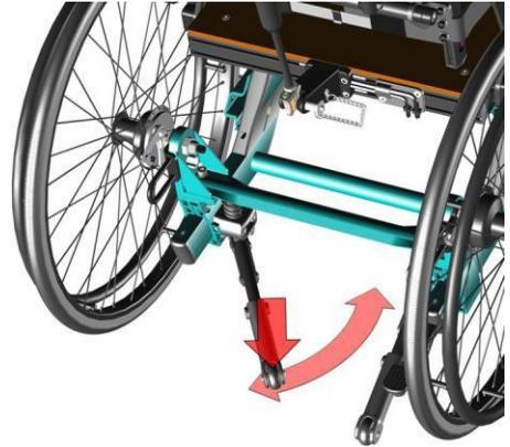
Der Kippschutz ist längenverstellbar durch die Verstellung des Endstücks. Lösen Sie die Schraube (A) und setzen Sie sie in das erforderliche Loch ein.
