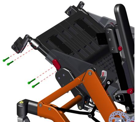
**Mit den verstellbaren Verlängerungsstücken der Beinstütze können Sie die Kniegelenke anpassen, wenn diese nicht auf das Kniegelenk der Beinstütze ausgerichtet sind.**
