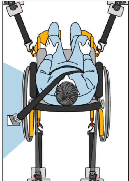
Verwendung eines Netti Rollstuhls als Sitz in einem Kraftfahrzeug
