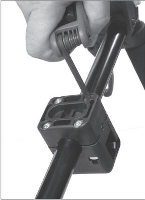
Le support d'appui-tête est fixé en serrant les quatre vis deux par deux en diagonale, de sorte que le support soit fixé avec la même force répartie sur les quatre vis.
