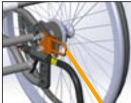
Per fissare la sedia a rotelle nel veicolo devono essere utilizzati solo i punti di fissaggio designati..
