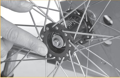
**i** Um zu kontrollieren, ob das Antriebsrad korrekt eingerastet ist, lassen Sie den Entriegelungsknopf los und ziehen das Antriebsrad.
