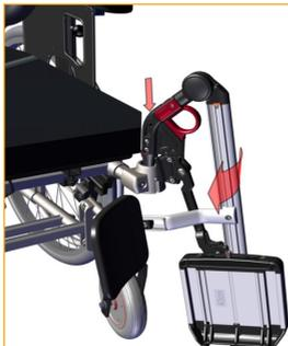
Um den Winkel der Beinstütze einzustellen, lösen Sie einfach den roten Hebel und heben oder senken ihn. Die Beinstütze bleibt in der Position, in der Sie den Hebel arretieren.
