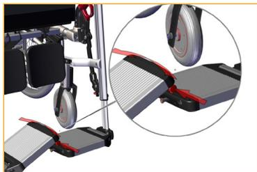
**i** Während der Einstellung müssen die Fußplatten unbelastet sein.
