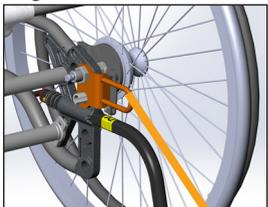
Der Winkel der Spangurte sollte möglichst genau 45° sein
