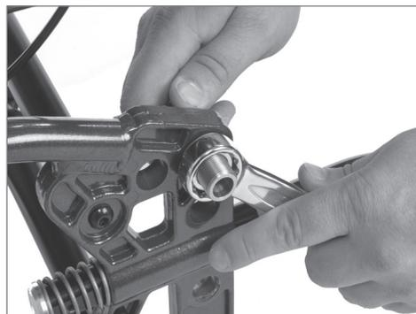
**i** S'assurer que l'écrou situé à l'intérieur du châssis entoure complètement la douille de roue.
