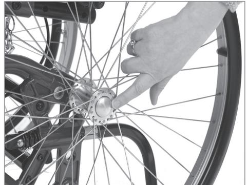
**i** Para comprobar que la rueda principal de 24" está correctamente sujeta al cubo, retire el dedo del pomo central y tire de la rueda principal.
