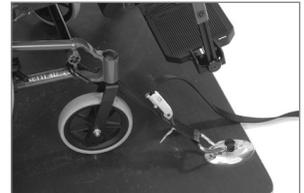
En la parte posterior: Monte la pieza de fijación al vehículo, una para cada rueda principal.
