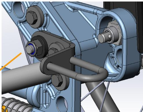
Für 16-Zoll-Räder installieren Sie den Autobefestigungssatz auf die gleiche Weise, aber verwenden Sie beide Schrauben, die im Satz enthalten sind.
