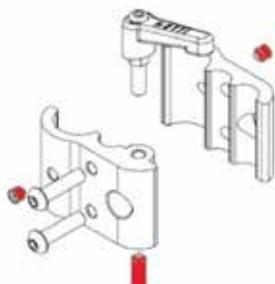
**i** Klämmans position kan säkras med 2:an på framsidan av klämman ytterligare stiftskruvar
