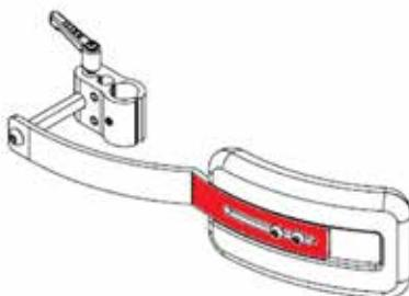
Um die Pelotte in der Tiefe an den Körper des Benutzers anzupassen, lösen Sie 2 Schrauben auf der Rückseite des Pelottenpolsters und verschieben Sie die Pelotte bis zur gewünschten Tiefe. Ziehen Sie die 2 Schrauben wieder fest an.
