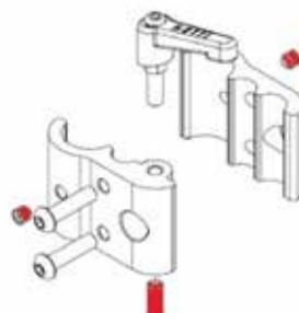
**i** Die Position der Klammer kann mit den vorne an der Klammer befindlichen 2 Madenschrauben zusätzlich gesichert werden.
