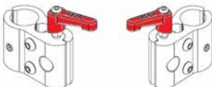
Um die Pelotte für links oder rechts zu nutzen, drehen Sie die Klammer um 180° Grad und schrauben Sie den Kipp-Klemmhebel oben ein und die Madenschraube unten.
