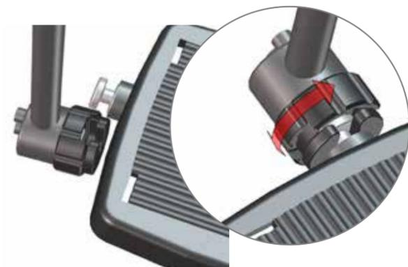
**Einstellung der Unterschenkel-Länge:** Lösen Sie jeweils links & rechts die Schrauben, stellen Sie die erforderliche Höhe ein und fixieren Sie die Schrauben wieder.
