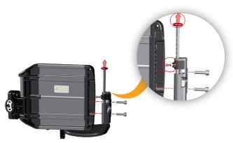
Je nachdem, wo die Verriegelung montiert ist, muss der Verriegelungsstift in der Länge angepasst werden.
