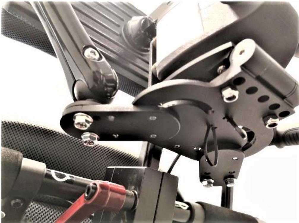
1. Montieren Sie die Halterung an den aktuellen Rollstuhl. Stellen Sie fest, ob die Luftblase in der Wasserwaage zentriert ist, dies zeigt den richtigen Winkel an und ist eine Voraussetzung dafür, dass die Begleitsteuerung zufriedenstellend funktionieren kann.
