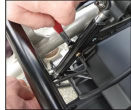
**Manuelle Verstellung der Sitzneigung mittels Gaszylinder.**
