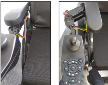
**⚠** Achten Sie darauf, dass der BUS-Kabel nicht enger als 50mm Radius gebogen wird ( orange markiert)
