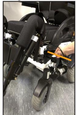
**⚠ Quetschgefahr bei Verstellung des Winkels der Fußstütze.**
