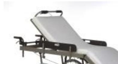
Die Unterschenkelauflage ist nicht als permanente Beinstütze konstruiert, sondern dient dem leichteren Manövrieren des Rollstuhls z.B. im Fahrstuhl.
