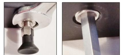
Prüfen Sie nun, ob die Verriegelungskugel glatt in die Aufnahme der Halterung fällt und justieren Sie wenn nötig den Verriegelungsstift oder die Stellschraube nach.
