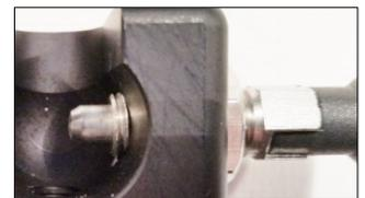
Mit Hilfe des Inbusschlüssels 5 können Sie die Stellschraube (Madenschraube) in der dem Verriegelungsstift gegenüberliegenden Bohrung anziehen und somit eine gewisse Spannung einstellen.
