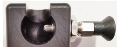
Ein zu weit in das Schraubengewinde eingeschraubter Verriegelungsstift verhindert, dass die Verschlusskugel vollständig in die Aufnahme der Halterung fällt.
