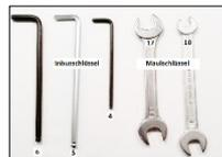
Beginnen Sie mit der Demontage des Standard-Verriegelungsstiftes. Um die Schraube und Mutter an der Unterseite des Fußbrettes zu entfernen, verwenden Sie den Inbusschlüssel 4 und den Maulschlüssel 10. Legen Sie Schraube und Mutter für die spätere Montage der verstärkten Verschlusskugel beiseite.
