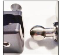
Basierend auf Ihrer Entscheidung, schieben Sie Verschlusskugel in das Rohr auf der Unterseite des Fußbrettes ein und befestigen Sie diese mit der Schraube und Mutter, die Sie bei der Demontage beiseitegelegt haben. Eine Montage in Vorwärtsrichtung bedeutet, dass das Loch in der Verriegelungskugel nach vorne zeigt, wenn das Fußbrett in die Gebrauchslage zurückgedreht wird.
