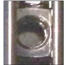
Führen Sie nun das Beinstützen-Rohr in die Halterung ein und platzieren Sie die kleinere Mutter mit Hilfe der Rückseite des Inbusschlüssels innerhalb des Rohres bis die Mutter mit dem oberen Loch im Verschluss in der Position übereinstimmt.
