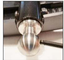
Der Verriegelungsstift kann nun an der Halterung angebracht werden. Schrauben Sie den Sicherungsstift soweit in die Halterung ein, dass sich das Ende des Gewindes in einer Linie mit der Innenkante des Loches befindet. Mit dem Maulschlüssel 17 die Mutter am Verriegelungsstift fest in dieser Position anziehen.
