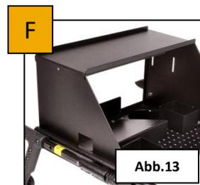
Das Kontrollsichtfenster und die obere runde Aufnahme für eine Sauerstoffflasche sind durch einen zusätzlichen Deckel verdeckt. Diesen können Sie entfernen, indem Sie die 2 seitlichen Schrauben lösen (Abb. 14).
