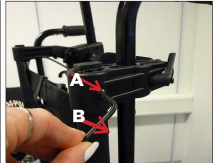
An sämtliche Modelle: Entfernen Sie die Schrauben **B** die zur Fixierung des einstellbaren Gurtrückens dienen.
