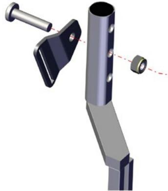
Montieren Sie die Gurthalterungen mit der Kröpfung nach innen wie gezeigt.
