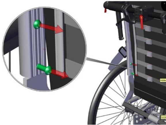
Befestigen Sie die Gurtbefestigungen mit den 2 M6 x 20mm Schrauben.
