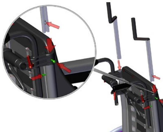
Das H-Gurt Adapter Kit für den Netti Mini verfügt über 2 Z-Profile mit jeweils 3 Löchern im oberen Bereich.
