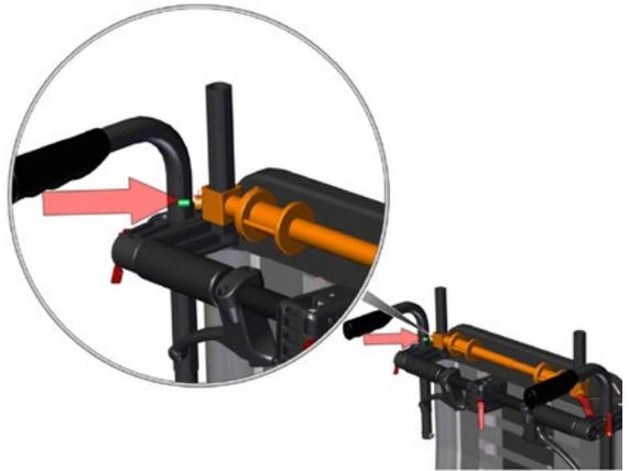
Mit einem Inbusschlüssel fixieren Sie die Gurtführungsrollen in der gewünschten Breite.
