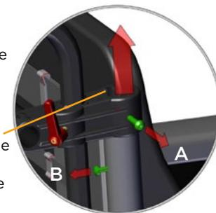
Entfernen Sie nun die den Rücken-Klettgurt haltende Schraube B.
