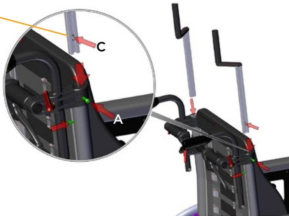
Die Schraube B dient außer der Fixierung des Rücken-Klettgurts auch der Höheneinstellung der Z-Profile.
