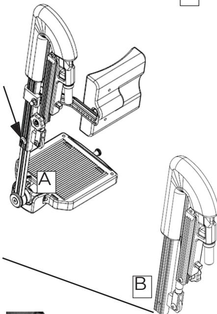
**2.** Führen Sie nun die Fußstützen-Einsteckrohre (1) des Fußkastens (2) in die Beinstützen ein (B) und drehen Sie die Schrauben wieder ein.
