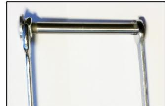
Falls die Mutter der Steckachse zu weit nach innen geschraubt sein sollte und die Steckachse in der Buchse somit nicht fixiert ist, schrauben Sie Mutter nach außen bis die Achse fest in der Buchse fixiert ist.
