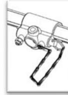
3. Lösen Sie nun die Fixiermutter am unteren Ende der Gasdruckfeder soweit, dass Sie die Gasdruckfeder drehen können.
