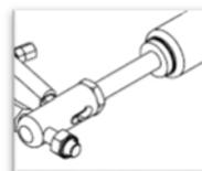
4. Drehen Sie nun die Gasdruckfeder etwas heraus. Dadurch wird der Gasdruckfeder-Auslösestift etwas nach hinten positioniert. Testen Sie, ob die Gasdruckfeder die Position hält, indem Sie die Sitzkantelung mit dem Handgriff auslösen.
