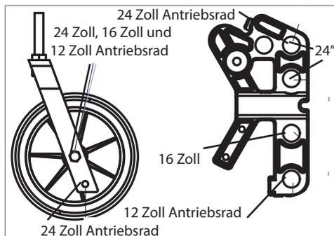
**i** Wenn die Sitzhöhe verändert wird, achten Sie darauf, dass die Vorderräder so positioniert werden, dass die Lager der Vorderräder senkrecht zum Boden stehen. Dies ist für ein gutes Fahrverhalten des Rollstuhls wichtig.
