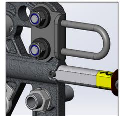
Befestigen Sie einen Haken/Karabiner in der Halterung. Der Winkel der Spanngurte sollte möglichst genau 45° sein.
