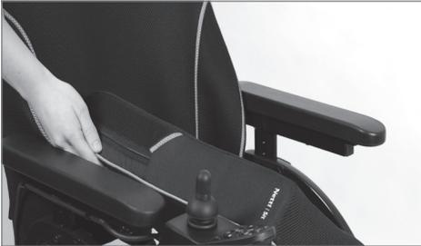
Die Befestigung des Rückenpolsters an der Rückenlehne erfolgt mit Klettverschluss.
