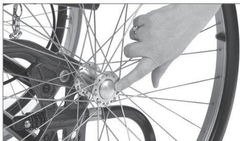
**i** Um zu kontrollieren, ob das Antriebsrad korrekt eingerastet ist, lassen Sie den Entriegelungsknopf los und ziehen das Antriebsrad.
