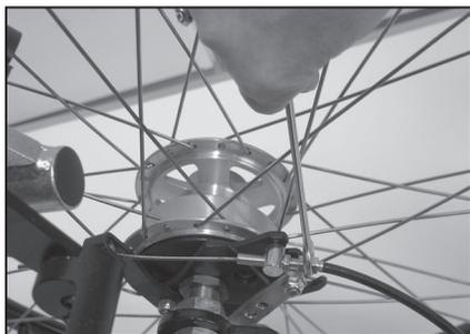
Si le frein ne freine pas correctement : dévissez la vis de tension de 2 à 4 tours pour régler le câble d'un ou des deux côtés. Recontrôlez les freins.
