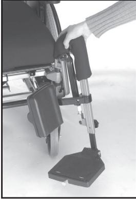
**Réglage de l'appui-mollet** L'appui-mollet est réglable en hauteur et en profondeur. Pour régler la hauteur, desserrez l'écrou qui se trouve à l'extérieur de la fixation de l'appui-mollet, sélectionnez la hauteur requise et refixez l'écrou (III. 6.14 A).
