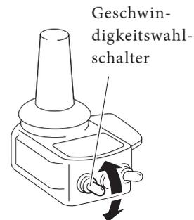
Die Geschwindigkeit ist in fünf Stufen einstellbar.
