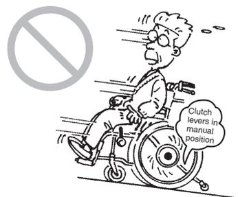
Wenn Sie die Kupplungshebel während der Fahrt vom Handbetrieb in den elektrischen Antrieb schalten, werden die Bremsen an den Hinterrädern angezogen. Das plötzliche Bremsen kann dazu führen, dass Ihr Körper nach vorne stürzt oder der Rollstuhl beschädigt wird.
