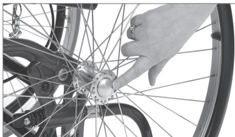
**i** Per verificare che la ruota posteriore sia correttamente fissata al mozzo, rimuovere la manopola centrale e tirare la ruota.
